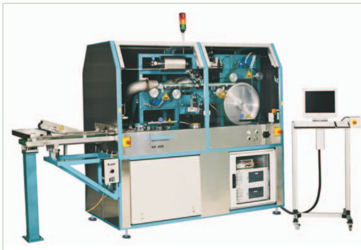
Die Münzprüfmaschine SIF2500 untersucht und sortiert Münzen und Münzrohlinge
